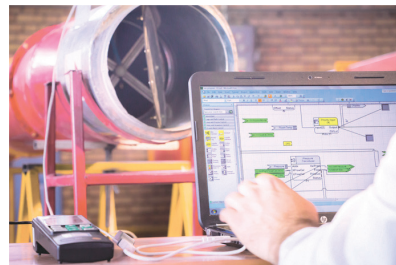
کالیبراسیون باکس های حجم هوای متغیر (VAV BOX) با نرم افزارهای TAC SCHNEIDER WORK PLACE و BELIMO PC TOOL
