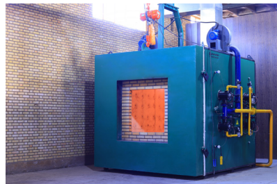
کوره 1200°C جهت تست دمپره های آتش و دود بر مبنای استانداردهای بین المللی UL555 و ISO 10294 و BS EN 1366
