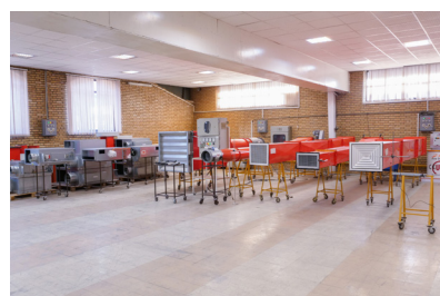
باندهای استاندارد جهت تست طول پرتاب و افت فشار ترمینالهای توزیع هوا براساس استانداردهای ملی ISIRI 7693 و ISO 5221 و استانداردهای بین المللی ISO 5219 و ISIRI 7695
