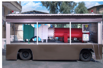
باند شبیه سازی موج انفجار با قابلیت تولید فشار 8bar جهت دمپر و دریچه های ضد انفجار تحت استاندارد های ASTM F 2912-04 ، ASTM F1642-04 ، 11 و GSA TS01-2003 و تست نشستی بر مبنای استاندارد AMCA500
