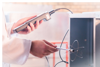
اندازه گیری سرعت، دبی و افت فشار ترمینال های توزیع هوا توسط دستگاه های testo ساخت کشور آلمان
