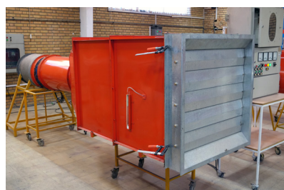
تست نشستی دمپرها بر اساس استانداردهای UL555S و AMCA 500 D با قابلیت ایجاد فشار 2000pa
