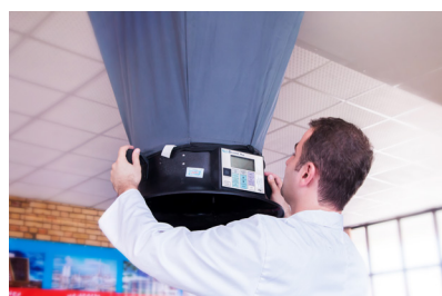
بالانس سیستم های تهویه مطبوع توسط دستگاه Air Capture hood (TSI AccuBalance)
